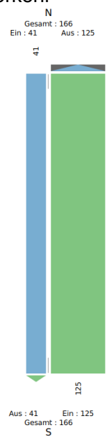
Abbildung 25 Knotenstrombelastungsplan des Kfz-Verkehrs am Querschnitt Q1 Am Kraftwerk; Zeitraum: Do., 23.10.2025, 06:15 Uhr bis Do., 23.10.2025, 07:15 Uhr [Kfz / h]; Klassen: Pkw, PkwA, Lkw, LkwA, Bus, Lfw, Krad, Sattel-Kfz
