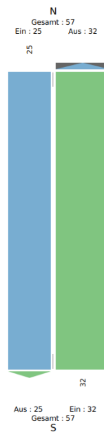
Abbildung 24 Knotenstrombelastungsplan des Schwerverkehrs am Querschnitt Q1 Am Kraftwerk; Zeitraum: Do., 23.10.2025, 00:00 Uhr bis Fr., 24.10.2025, 00:00 Uhr [Kfz / 24 h]; Klassen: Lkw, LkwA, Bus, Sattel-Kfz
