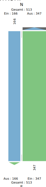
Abbildung 59 Knotenstrombelastungsplan des Kfz-Verkehrs am Querschnitt Q2 Hauptstr. (S71); Zeitraum: Do., 23.10.2025, 06:15 Uhr bis Do., 23.10.2025, 07:15 Uhr [Kfz / h]; Klassen: Pkw, PkwA, Lkw, LkwA, Bus, Lfw, Krad, Sattel-Kfz
