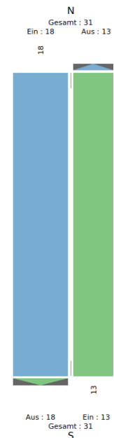
Abbildung 60 Knotenstrombelastungsplan des Schwerververkehrs am Querschnitt Q2 Hauptstr. (S71); Zeitraum: Do., 23.10.2025, 06:15 Uhr bis Do., 23.10.2025, 07:15 Uhr [Kfz / h]; Klassen: Lkw, LkwA, Bus, Sattel-Kfz
