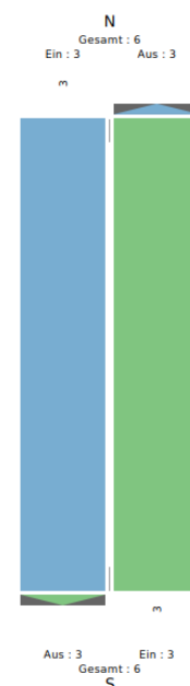
Abbildung 26 Knotenstrombelastungsplan des Schwerververkehrs am Querschnitt Q1 Am Kraftwerk; Zeitraum: Do., 23.10.2025, 06:15 Uhr bis Do., 23.10.2025, 07:15 Uhr [Kfz / h]; Klassen: Lkw, LkwA, Bus, Sattel-Kfz
