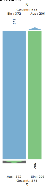
Abbildung 61 Knotenstrombelastungsplan des Kfz-Verkehrs am Querschnitt Q2 Hauptstr. (S71); Zeitraum: Do., 23.10.2025, 14:45 Uhr bis Do., 23.10.2025, 15:45 Uhr [Kfz / h]; Klassen: Pkw, PkwA, Lkw, LkwA, Bus, Lfw, Krad, Sattel-Kfz
