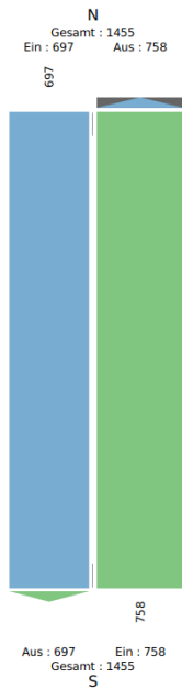
Abbildung 23 Knotenstrombelastungsplan des Kfz-Verkehrs am Querschnitt Q1 Am Kraftwerk; Zeitraum: Do., 23.10.2025, 00:00 Uhr bis Fr., 24.10.2025, 00:00 Uhr [Kfz / 24 h]; Klassen: Pkw, PkwA, Lkw, LkwA, Bus, Lfw, Krad, Sattel-Kfz
