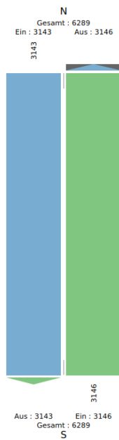
Abbildung 57 Knotenstrombelastungsplan des Kfz-Verkehrs am Querschnitt Q2 Hauptstr. (S71); Zeitraum: Do., 23.10.2025, 00:00 Uhr bis Fr., 24.10.2025, 00:00 Uhr [Kfz / 24 h]; Klassen: Pkw, PkwA, Lkw, LkwA, Bus, Lfw, Krad, Sattel-Kfz
