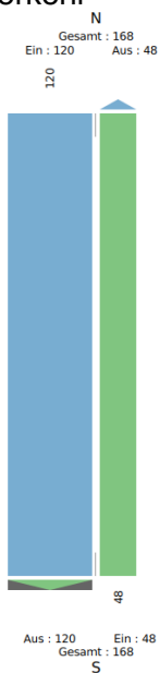
Abbildung 27 Knotenstrombelastungsplan des Kfz-Verkehrs am Querschnitt Q1 Am Kraftwerk; Zeitraum: Do., 23.10.2025, 15:00 Uhr bis Do., 23.10.2025, 16:00 Uhr [Kfz / h]; Klassen: Pkw, PkwA, Lkw, LkwA, Bus, Lfw, Krad, Sattel-Kfz
